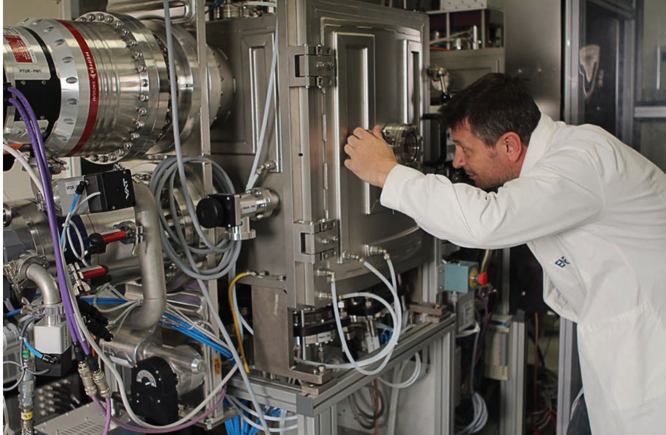
■ CR-Brindisi MATAS, Laboratorio Materiali Funzionali e Tecnologie per Applicazioni Sostenibili. Impianto Multicamera per deposizione di film sottili
