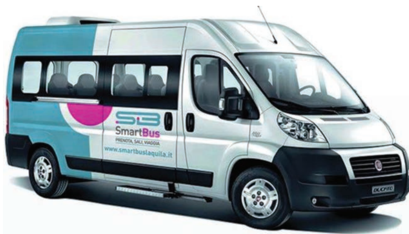
■ Figura 1. SmartBus è un servizio sperimentale di BUS «a chiamata», sperimentato per 6 mesi dall'ENEA nel centro storico de L'Aquila. Il sistema acquisisce le richieste di trasporto pervenute da parte dell'utenza, e le gestisce comunicando (anche tramite SMS), la fermata e l'orario di prelievo, con l'ottimizzazione del percorso e del servizio nel rispetto dei vincoli di autonomia consentiti dalle batterie e dalle infrastrutture di ricarica rapida
