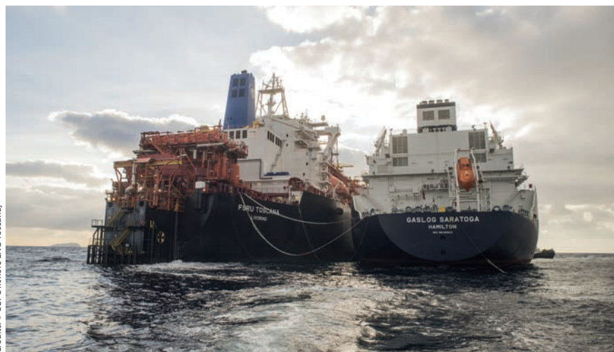
■ Operazione di trasferimento del GNL dalla nave metaniera al terminale galleggiante di rigassificazione OLT Offshore LNG Toscana
