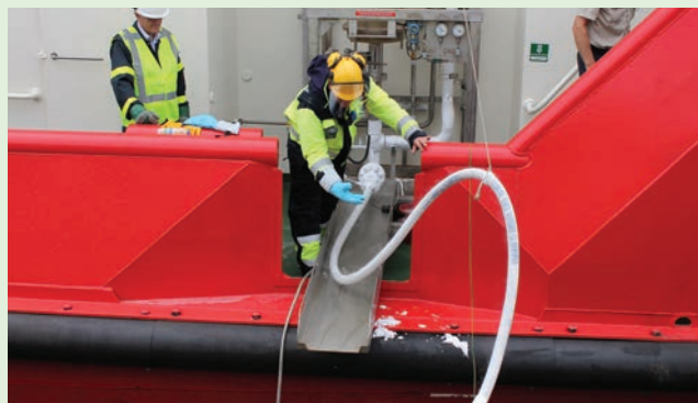
■ Finita l'operazione si stacca il tubo di rifornimento dall'autobotte. Contemporaneamente si stacca il tubo anche dal lato rimorchiatore. Operazione conclusa
