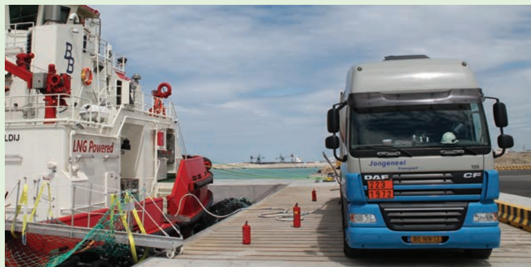
■ Il tubo speciale per il trasferimento del GNL è stato collegato e tutto è pronto per iniziare l'operazione
