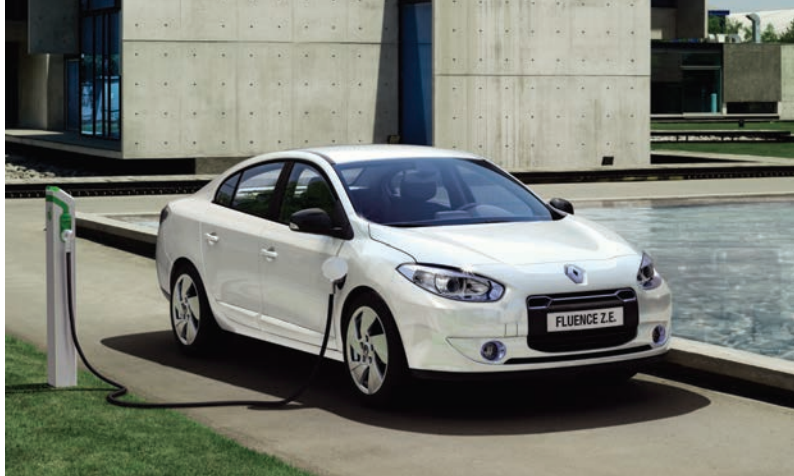
■ La Fluence Z.E., lunga 4,7 m e larga 1,8 m, ha una autonomia di 185 km (ciclo NEDC), un prezzo di 28.200 euro IVA inclusa e un canone mensile per il noleggio della batteria di 82 euro IVA inclusa
