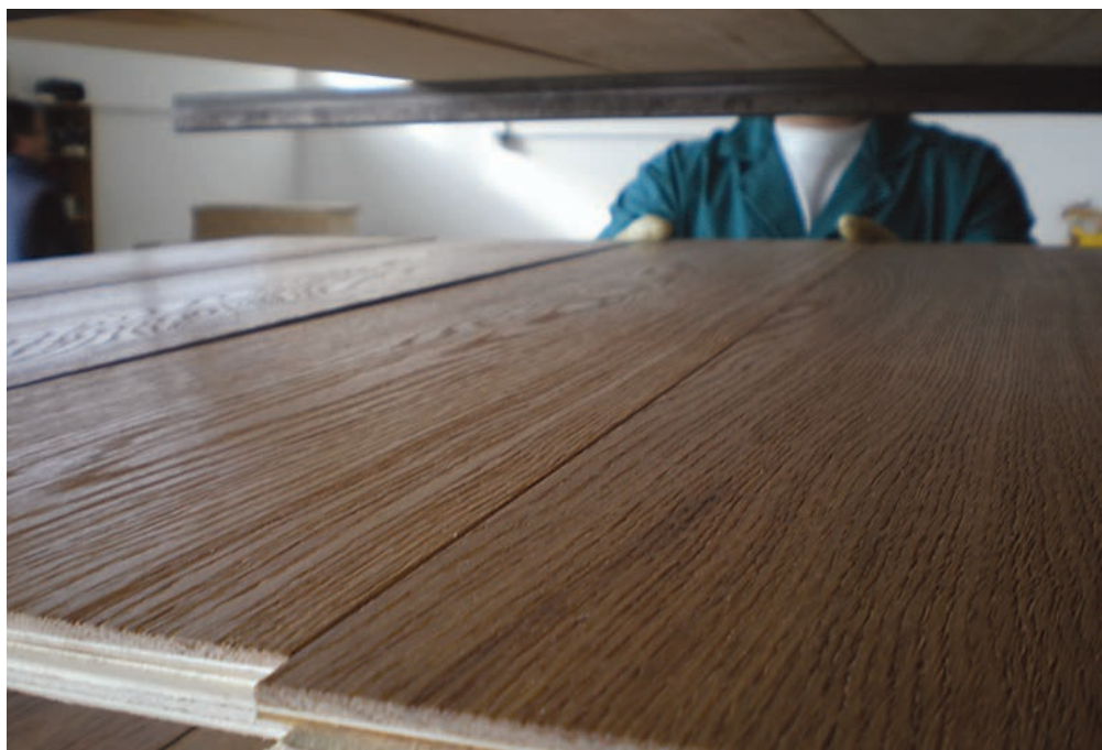
■ Dopo la stagionatura naturale e la fase di verniciatura, le tavole di legno vengono stabilizzate mediante graduale essiccazione
